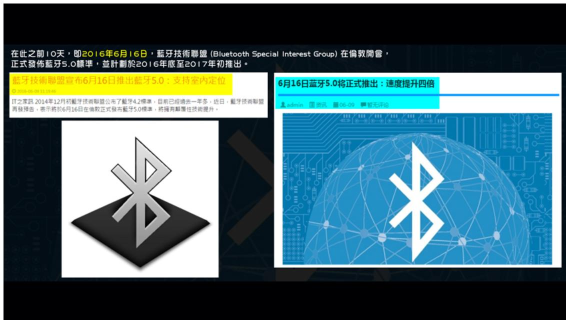
藍牙 5.0 擁有顛覆性的技術提升，實現 4 倍通訊距離、2 倍傳輸速度及 8 倍廣播資料傳輸量，大幅提升傳輸速度和距離，實現「非連線式」物聯網，提升家庭、商用及工業用 Beacon 與定位應用技術，尤其針對低功耗設備，具有更廣闊的覆蓋範圍及較現時快四倍的速度提升，同時加入室內定位輔助功能，結合 Wi-Fi 使用，更可以實現準確度少於 1 米的室內定位。上年 2015 年台北電腦展，
